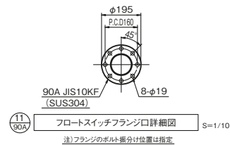
フロートスイッチフランジ詳細図 S=1/10
